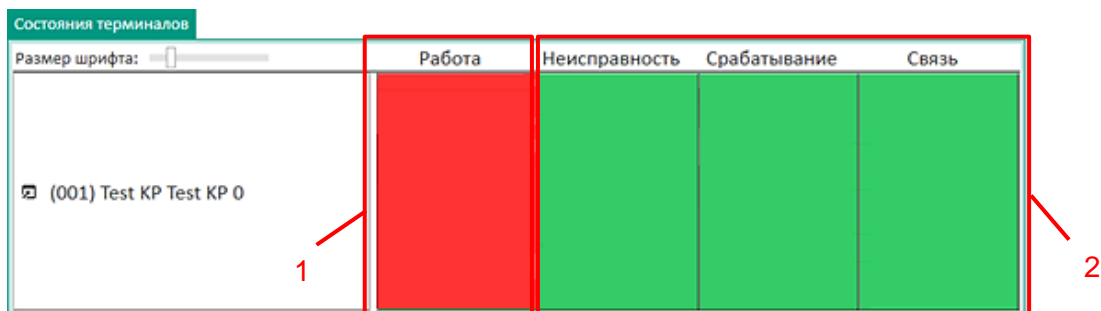
Рисунок 7 – Терминал не готов к работе
